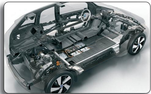
Hersteller sportlicher Fahrzeuge versuchen mit allen verfügbaren Mitteln, den **Schwerpunkt des Fahrzeuges möglichst tief und möglichst in die Mitte des Fahrzeuges** hinzubekommen.
