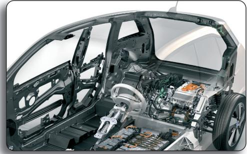
Fälschlicherweise wird angenommen, der Motorblock in der Front eines Fahrzeuges dient dem Aufprallschutz. Das Gegenteil ist der Fall, der **Motorblock reduziert die Knautschzone**, wodurch ein Anprall höhere Belastungen für die Insassen bedeutet.
